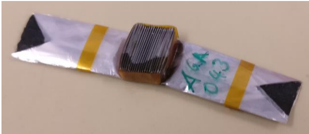
Gedruckter und gefalteter otego-Generator (links), Röntgenschnitt mit Schichtung durch einen fertigen Generator (rechts)
