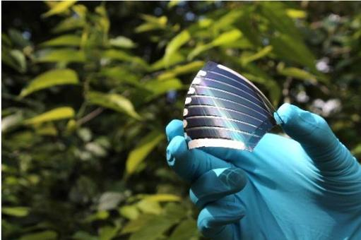
Flexibles, gedrucktes organisches Solarmodul.
